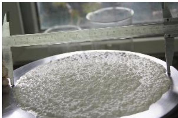
Рис. 2. Улучшение растекания массы с использованием диспергирующего глинозема
